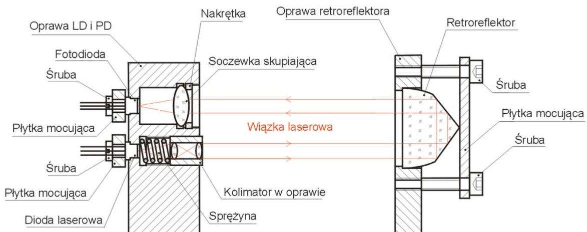
Rys. 2. Sposób montażu elementów układu bariery laserowej (LD – dioda laserowa, PD – fotiodioda) – widok przekrojowy (źródło: Autorzy)
