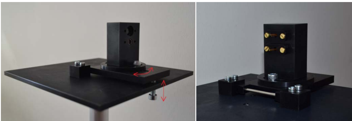
Fot. 2. System pozycjonujący oprawy układu nadawczo-odbiorczego (źródło: Autorzy)
