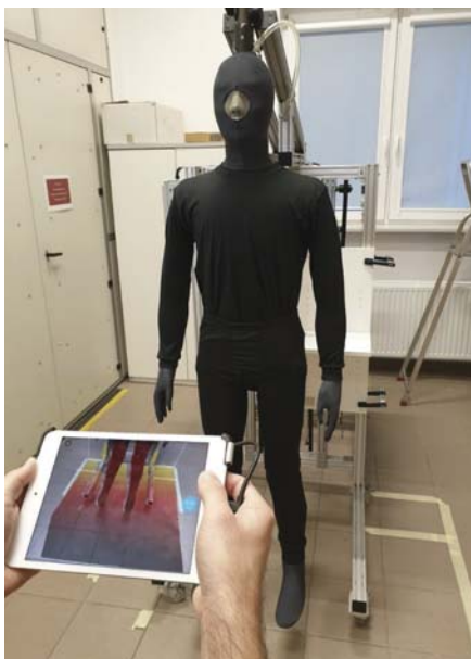
Fot. 3. Określenie objętości, w której oprogramowanie buduje trójwymiarową siatkę Photo 3. Determining the volume in which the software builds a three-dimensional mesh
