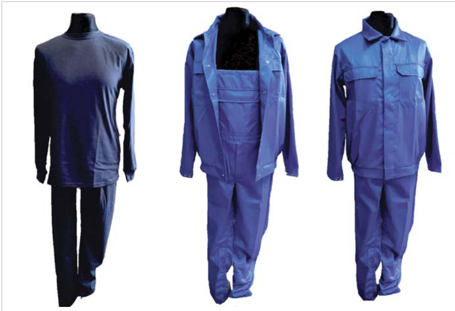
Fot. 1. Bielizna oraz kwasoodporna odzież ochronna zastosowane do badań (opracowanie własne) Photo 1. Tested underwear and acid-resistant protective clothing (own source)
