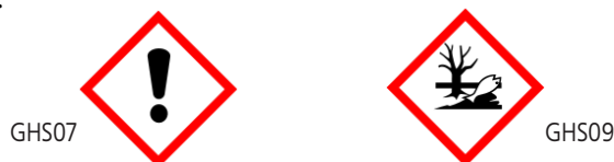
Ryc. 1. Piktogramy określone w załączniku do rozporządzenia WE nr 1272/2008 (CLP) mają czarny symbol na białym tle z czerwonym obramowaniem, na tyle szerokim, aby było wyraźnie widoczne
