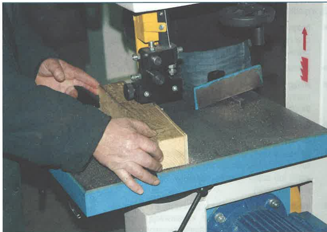
Rys. 4. Operator pilarki taśmowej często jest zmuszony operować dłońmi bardzo blisko narzędzia tnącego
