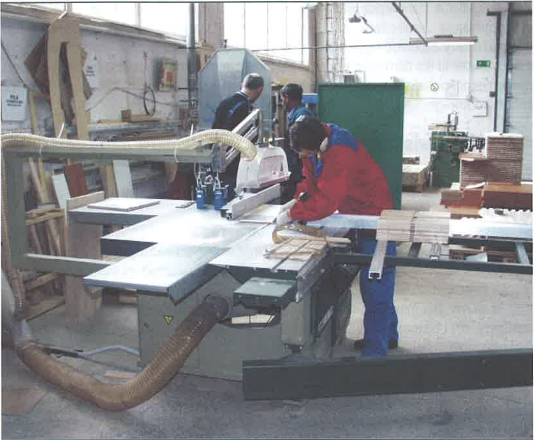
Rys. 10. Ustawiony za pilarem ekran ograniczający strefę zagrożenia odrzutem
