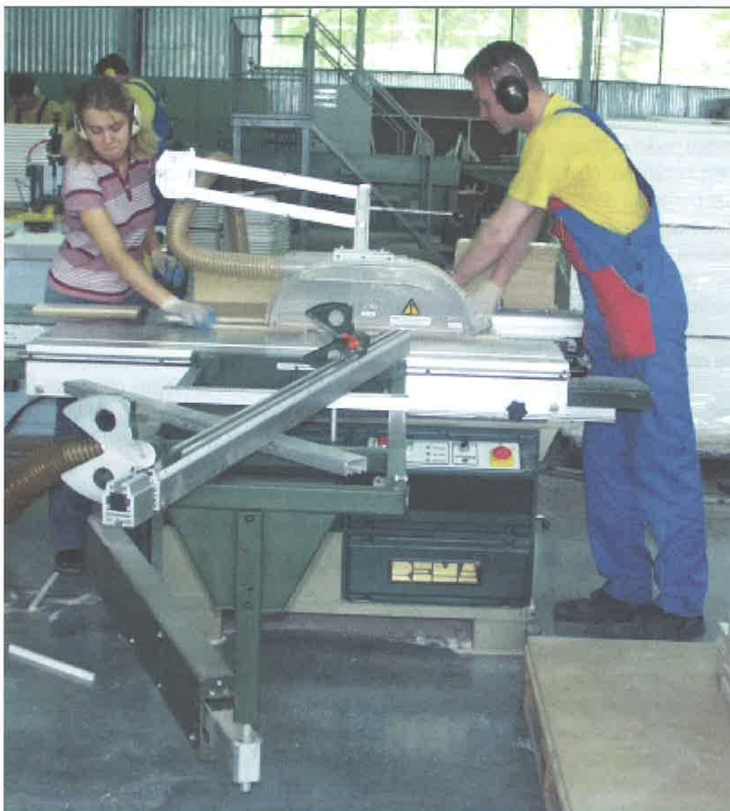
Rys. 11. Zapewnienie stateczności maszyny oraz podparcia materiału jest kluczowym warunkiem w zapewnieniu bezpieczeństwa podczas obróbki drewna
