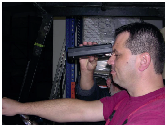
Rys. 2. Sposób stosowania dalmierza laserowego do pomiaru odległości W
