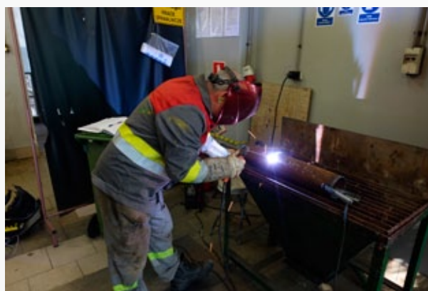
Fot. 4. Przykładowe stanowisko spawania elektrycznego (MMA) Photo 4. An example of the station for MMA welding
