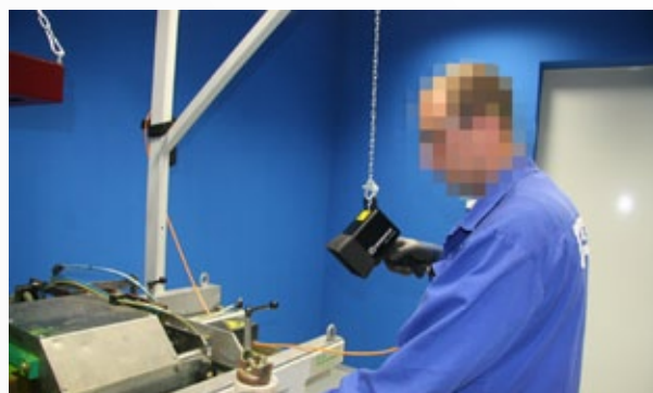
Fot. 1. Stanowisko defektoskopu z rtęciową oprawą ręczną Photo 1. The stand of the flaw detector with mercury manual binding
