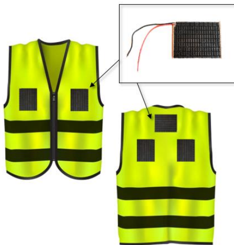
Projekt III.PB.09. Schemat przedstawiający projektowany sposób rozmieszczenia ogniw termoelektrycznych w odzieży ochronnej z funkcją aktywnego chłodzenia
