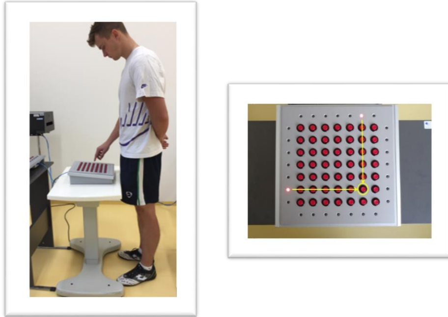
Rys.13. Badanie koordynacji wzrokowo-ruchowej w teście krzyżowym: a) aparat krzyżowy ze zobrazeniem zasady wykonania zadania przez osobę badaną; b) pozycja ciała badanego w czasie przeprowadzania testu
