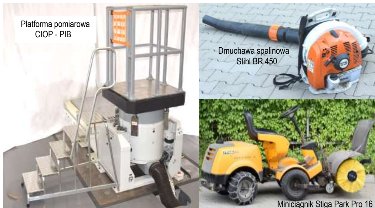
Fot. 4. Wybrane do badań urządzenia generujące drgania ogólne
