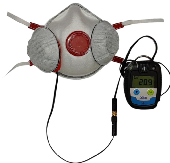
Rysunek 1 Półmaska filtrująca wyposażona we wskaźnik tlenu.
