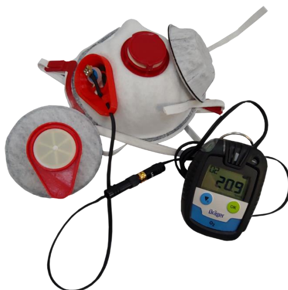
Rysunek 2 Sposób zamontowania sensora tlenu w konstrukcji półmasksi filtrującej.
