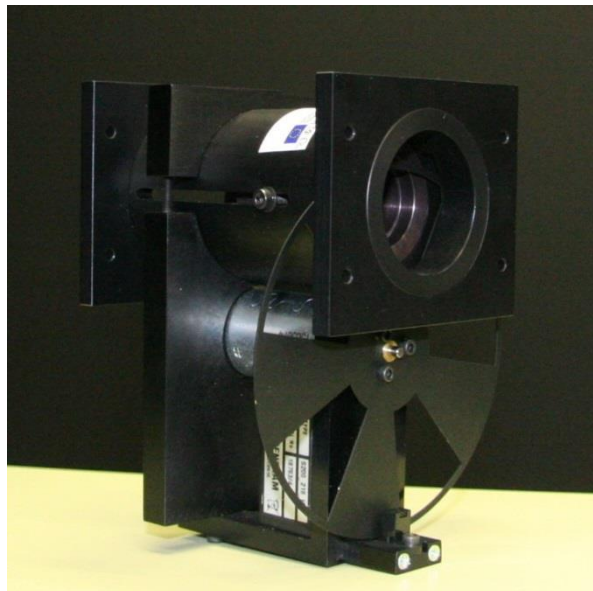
Rys. 9. Przekąźnikowy element optyczny z łopatką z pięcioma otworami
