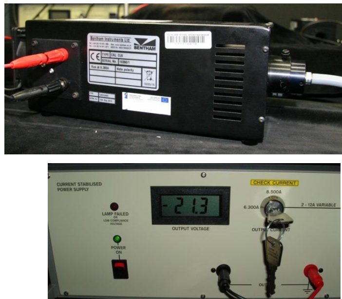
Rys. 7. Kwarcowe-halogenowe źródło wzorcowe CL 6 oraz zasilacz prądu stałego typ 605
