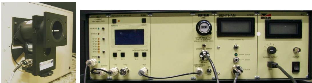
Rys. 10. Kompletny przekaźnikowy element optyczny zamontowany do wejścia monochromatora oraz zasilacz typ 417
