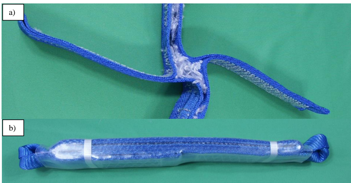
Rys. 1. Uszkodzenie powstałe w amortyzatorze włókienniczym pod wpływem jego „silnego” obciążenia: a) amortyzator „rozłożony” – widoczne pęknięcia szwów, b) amortyzator zapakowany – brak widocznych uszkodzeń.
