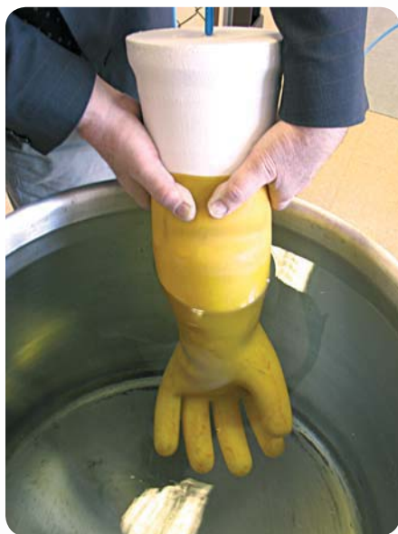
Fot. 3. Próba szczelności Photo 3. Tightness trial
