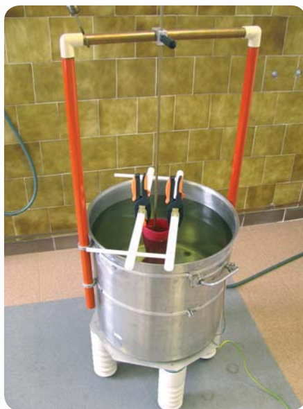
Fot. 4. Badanie elektryczne rękawicy elektroizolacyjnej Photo 4. Electricity trial of an insulating glove
