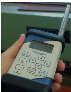
Rys. 5. Pomiar parametrów amplitudowych hałasu impulsowego przeprowadzany z użyciem miernika poziomu dźwięku
