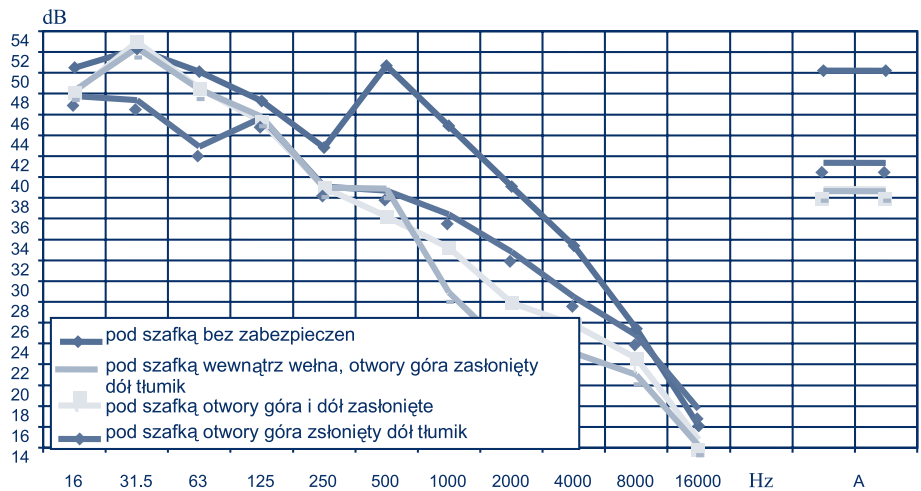
Rys. 11. Widma hałasu na stanowisku pracy przy stoliku dla różnej konfiguracji zabezpieczeń przeciwhałasowych
