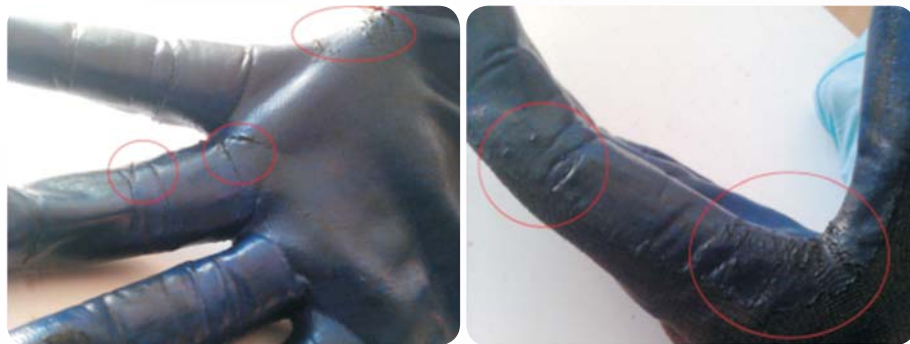
Fot. Przykładowe uszkodzenia rękawicy ochronnej (pęknięcia warstwy polimerowej) po badaniach użytkowych na stanowiskach pracy, wskutek jednoczesnego wpływu czynników mechanicznych oraz chemicznych – oleju mineralnego [fot. aut.] Photo. An example of a damaged protective glove (cracking of the polymer layer) due to actual usage at the worksite, associated with simultaneous exposure to both mechanical and chemical factors – mineral oils [author's photo]
