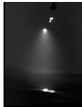
Rys. 6. Wyładowanie snopiaste ze źródła ciągłego
