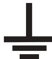
URZĄDZENIE MUSI BYĆ UZIEMIIONE!
