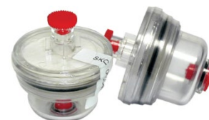
Fot. Próbnik DPM z impaktorem odcinającym frakcje < 1 \mu\text{m} (fot. https://www.airmet.com.au/dies-el-particulate-matter-dpm-cassettes )
