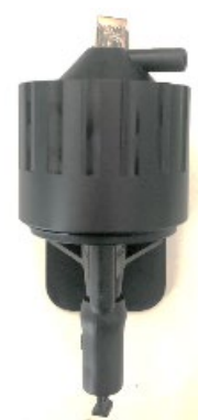
Fot. Oprawa do próbnika DPM z cyklonem do pobierania spalin Diesla (fot. własna)
