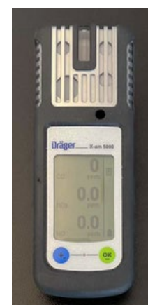
Fot. Analizator tlenków azotu i tlenku węgla (fot. własna)
